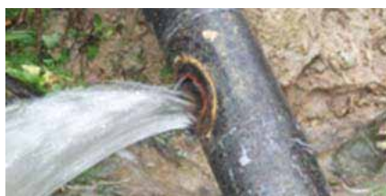
Figura 38: Vazamento provocado por corrosão em tubo.
