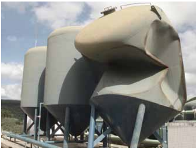
Figura 11: Decantador deformado por pressão atmosférica.
